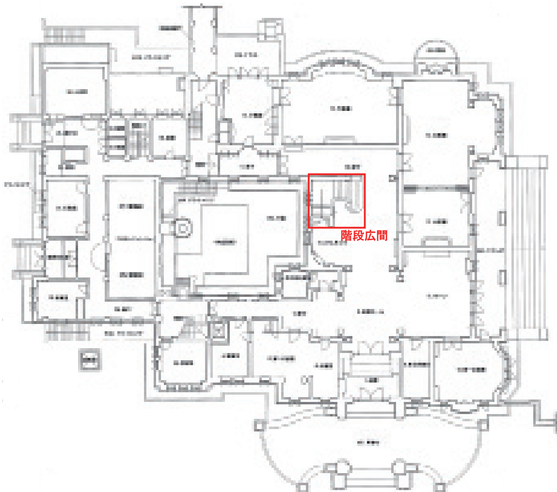
図6 旧前田家本邸洋館 階段位置
