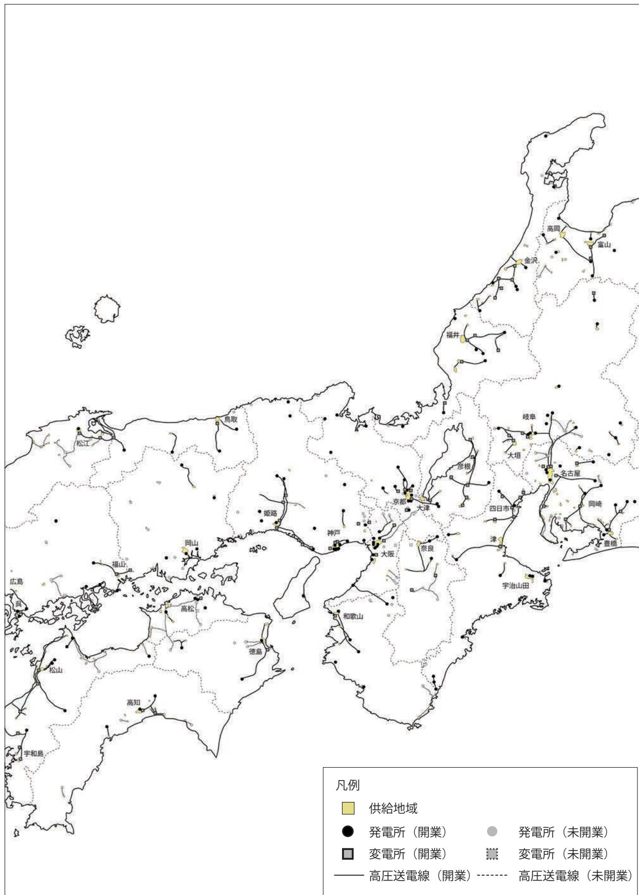
図5 明治45年時点の電力供給設備（中部・近畿・中国・四国エリア）
